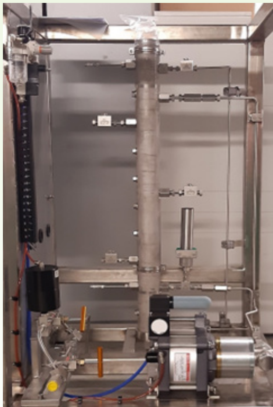
Hiilidioksidiuuttoon valmistunut jatkuvatoiminen reaktori.
