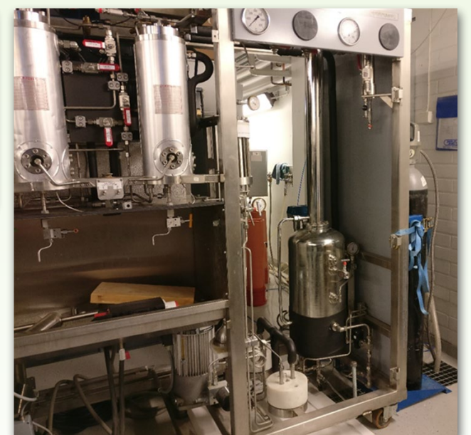
Kuva 2. Panostoisuuden uuttoprosessin rinnalle rakennettavassa jatkuvatoimisessa versiossa hyödynnetään nykyisiä hiilidioksidin varastointi- ja erotusyksiköitä sekä korkeapainepumppuja.
