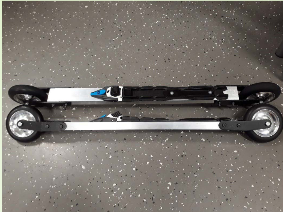
Kuva 2. HYTELI-hankkeessa kehitetty prototyyppi alumiinirunkoisista testirullasuksista, joihin integroidaan voima-anturoinnit pyöräripustuksiin sekä rungon sisään.
