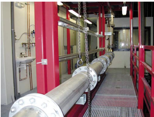
In-Line Pulp -laboratoriossa voidaan testata paperi- ja selluteollisuuden mittalaitteita.
